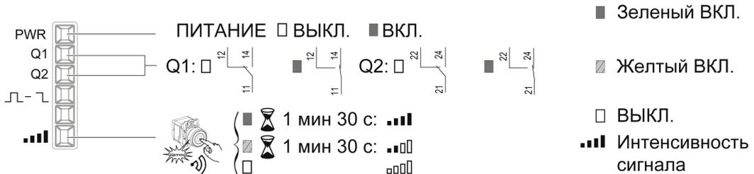
**Примечание:** СДИ интенсивности сигнала указывает значение последнего принятого сигнала. Тайм-аут для данного СДИ составляет 1 мин 30 с. Данный СДИ также может быть отключен посредством однократного нажатия кнопки выбора приемника.
