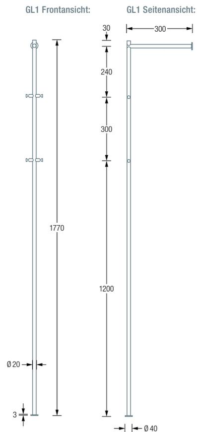
\*Edelstahl-Senkkopfschraube d 7 x 60 mm mit Rahmendübel 10 mm (HRD-CR 10 x 60).
