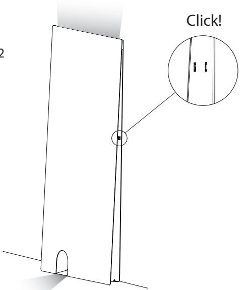
ES 4.1 Para fijar la lámpara, posicionar los orificios (F) con los anclajes (A).
