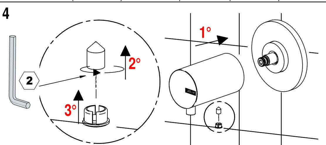
**! SOSTITUZIONE VITONE / VALVE REPLACEMENT**
