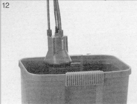
Поместите насос в воду (Рис. 12). Следите за тем, чтобы насос стоял действительно на дне емкости. Вставьте вилку штепсельного разъема силового кабеля трансформатора в розетку электросети и насос начнет работать. Продолжительность пробного пуска - приблизительно 1 минута. Проверьте все соединения на плотность.
