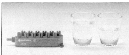
Серый капельный распределитель 2, предназначен для растений со средним потреблением воды. Расходует приблизительно 30 мл на один канал в день, что соответствует содержанию приблизительно 1½ стаканов воды.
