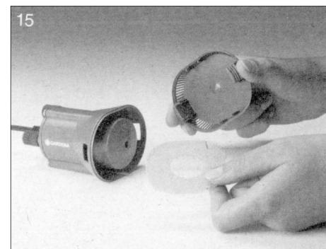
Комплект практически не требует обслуживания. После окончания использования комплекта, необходимо очистить пенопластовый фильтр насоса. Для этого снимите оранжевое основание насоса, нажав деблокирующую кнопку фиксатора, выньте фильтр (Рис. 15) и вымойте его в чистой воде.
