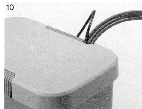
Емкость для воды GARDENA (8) обеспечивает полную загрузку, т.е. одновременно все выходы капельных распределителей (3x12) подают воду приблизительно неделю. Если Вы уезжаете надолго, то действуйте в соответствии с разделом "Подбор емкости для воды".
