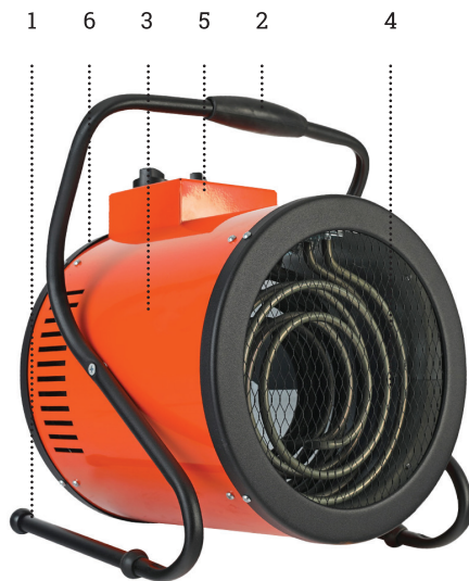
Рис. 1. Устройство прибора ЕНСИ-9: 1) подставка, 2) ручка, 3) поворотный корпус, 4) воздуховыпускная решетка, 5) блок управления 6) воздухозаборная решетка
