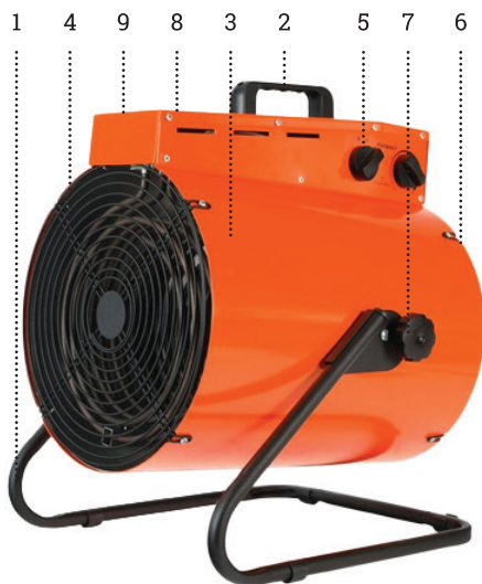
Рис. 1-1. Устройство прибора ЕНСИ-15: 1) подставка, 2) ручка, 3) поворотный корпус, 4) воздуховыпускная решетка, 5) блок управления, 6) воздухозаборная решетка, 7) барашковый винт, 8) Кнопка сброса аварийного термостата, 9) Трехфазная вилка
