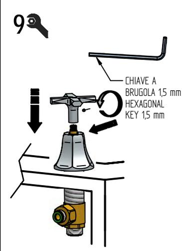
**! SOSTITUZIONE VITONE / CERAMIC DISC VALVE**
