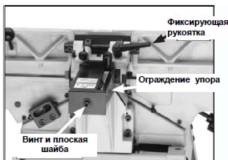
Рис. 12 Ограждение упора установлено
