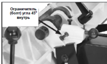
Рис. 44 Ограничитель упора для работы под углом 45° внутрь
