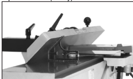
Рис. 43 Упор наклонен под углом 45° внутрь
