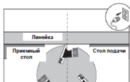
Рис. 41 Установка стола подачи вровень с приемным столом
