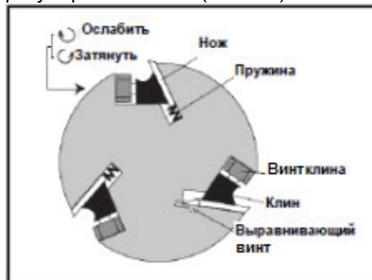
Рис. 38 Ножевой вал в разрезе
