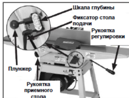
Рис. 18 Расположение элементов настройки стола
