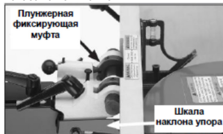
Рис. 45 Установка упора в положение 90°
