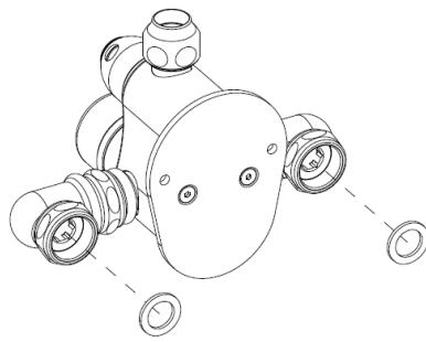
Inserire le guarnizioni di tenuta nelle calotte di serraggio.
