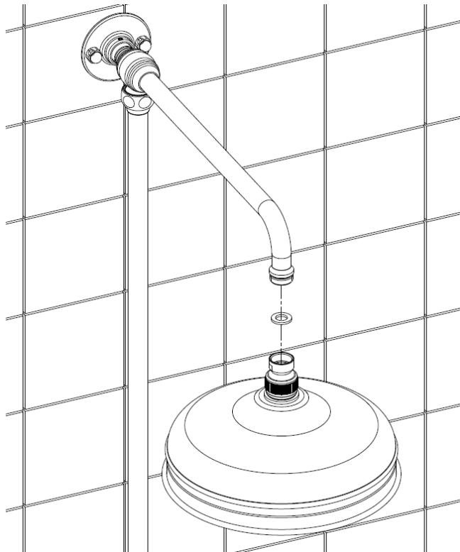
Avvitare il soffione all'attacco da 1/2" del tubo.
