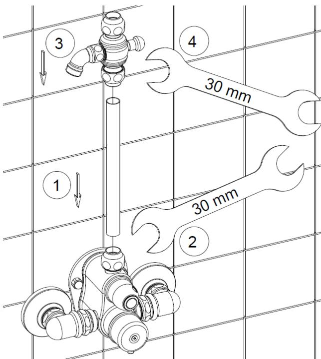
Inserire il tubo più corto nel miscelatore termostatico e serrare la calotta con chiave inglese da 30 mm.
