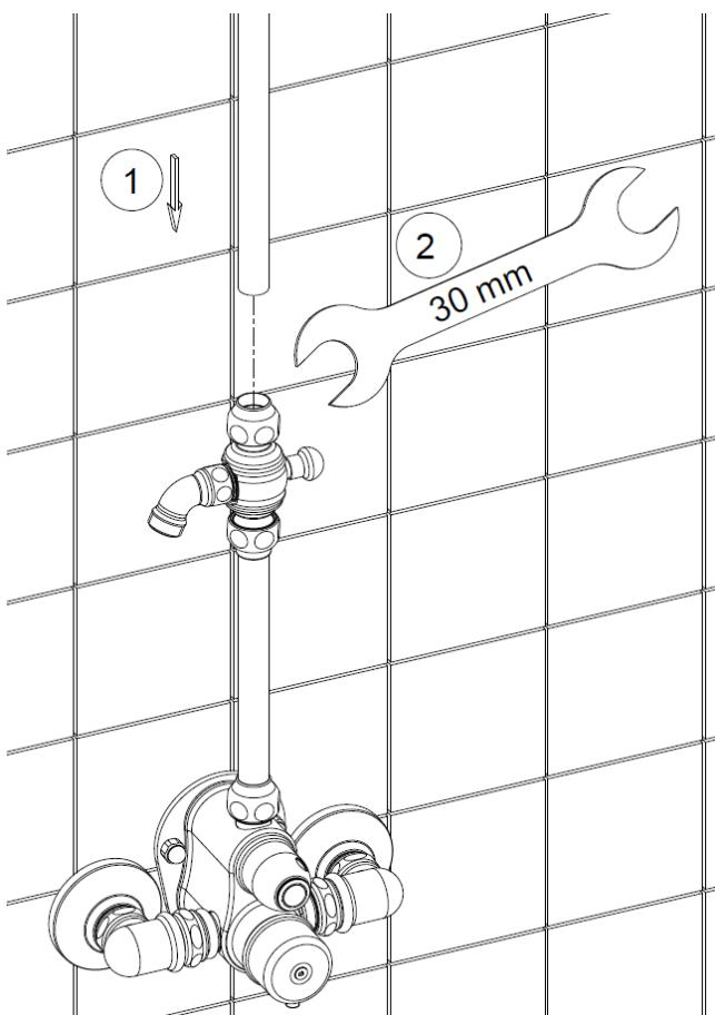
Inserire il tubo più lungo nel deviatore e serrare la calotta con chiave inglese da 30 mm.
