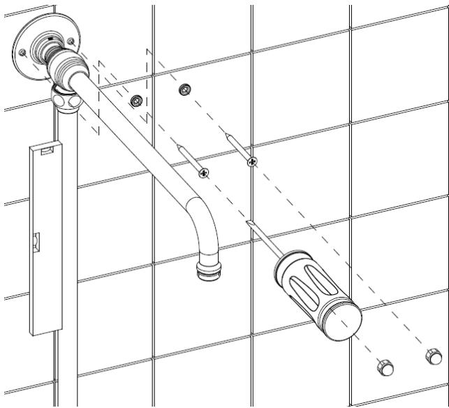
Con l'ausilio di una livella posizionare correttamente in bolla la colonna.
