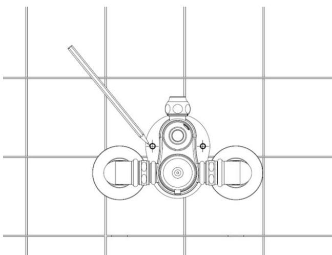
Markare la posizione dei fori di fissaggio.
