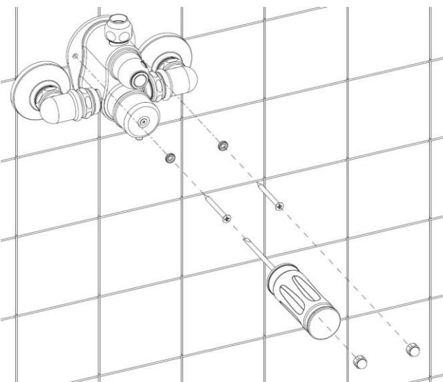
Fissare il miscelatore termostatico alla parete serrando le viti, interponendo i raccordi filettati.
