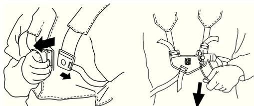
Удостоверьтесь, что привязные ремни оснастки были правильно расположены. Когда машина будет отрегулирована, проверьте работу системы быстрого отстегивания оснастки.
