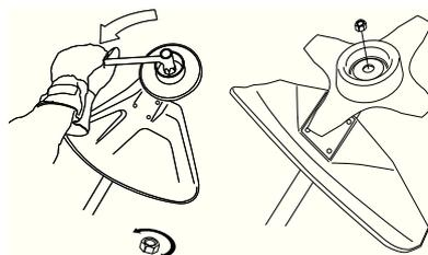
Нейлоновая прокладка контргайки не должна быть изношена настолько, чтобы ее можно было поворачивать вручную. Прокладка должна выдерживать усилие минимально 1,5 Нм. Гайку следует заменить после ее использования приблизительно 10 раз.
