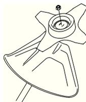
При сборке надо затягивать гайку против направления вращения режущего оборудования. При разборке надо отвинчивать гайку в направлении вращения режущего оборудования. (ЗАМЕЧАНИЕ! Гайка имеет левостороннюю резьбу.) Затягивать гайку следует торцевым ключом.
