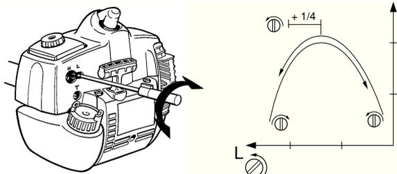
**ВНИМАНИЕ!** Если режущее оборудование вращается или подвижно при работе на холостых оборотах, винт Т следует вращать против часовой стрелки до тех пор, пока режущее оборудование не остановится.
