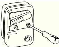
Если глушитель на вашей машине дополнительно оборудован искрогасящим фильтром, его следует регулярно прочищать. Забившийся фильтр может вызвать перегрев двигателя и привести к серьезным повреждениям двигателя.
