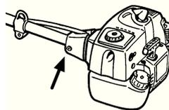
Неправильно закрепленная леска или незаточенное, неправильно режущее оборудование (не соответствующий тип или неправильно заточенные, см. раздел Заточивание лезвия) способствуют увеличению вибрации.
