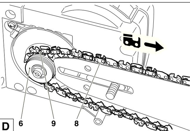
Пильную шину надо слегка прижать левой рукой к креплению на корпусе и провести пильную цепь (9) через направляющую звездочку (10) пильной шины, слегка натягивая при этом пильную цепь в направлении стрелки.
