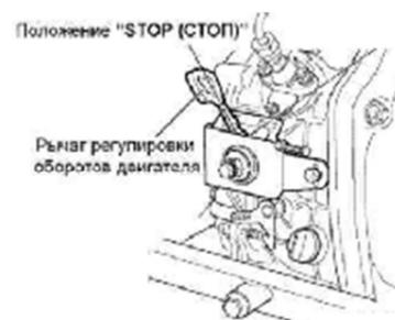
2. Установите рычаг регулировки оборотов двигателя в положение "STOP" (СТОП). Если двигатель продолжает работать после перевода рычага регулировки оборотов в положение "STOP" (СТОП), поверните топливный кран в положение "CLOSE" (ЗАКРЫТО) или открутите гайку топливного трубопровода высокого давления на стороне насоса, чтобы заглушить двигатель.
