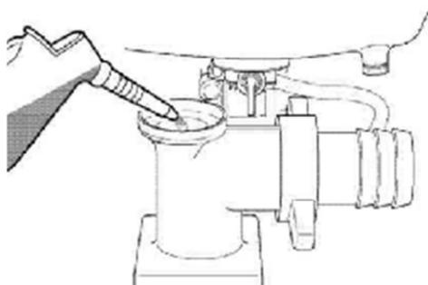
2. Если вода не подается в течении 5 минут, снимите пробку и долейте воду в мотопомпу. Если мотопомпа работает долго без подачи воды, это может означать неисправность узлов мотопомпы.
