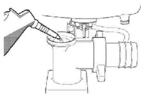
Самозаливка выполняется не мгновенно. Для этого насосу требуется от 1 до 10 минут, в соответствии с длиной всасывающего шланга и диаметром всасывания.
