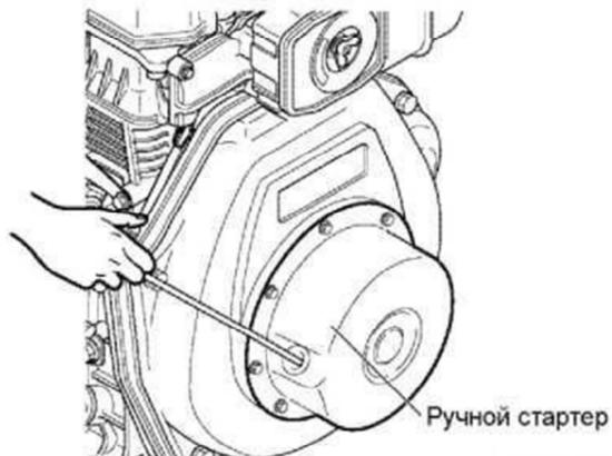
2.2-Опустите рычаг сброса давления. Он возвращается автоматически, если ручной стартер (трос) вытянут.
