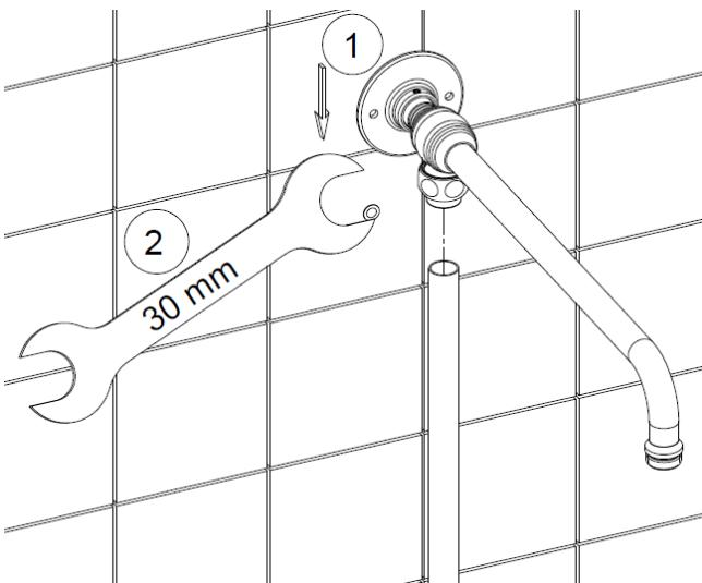
Inserire il braccio sul tubo colonna e serrare la calotta con chiave inglese da 30 mm.
