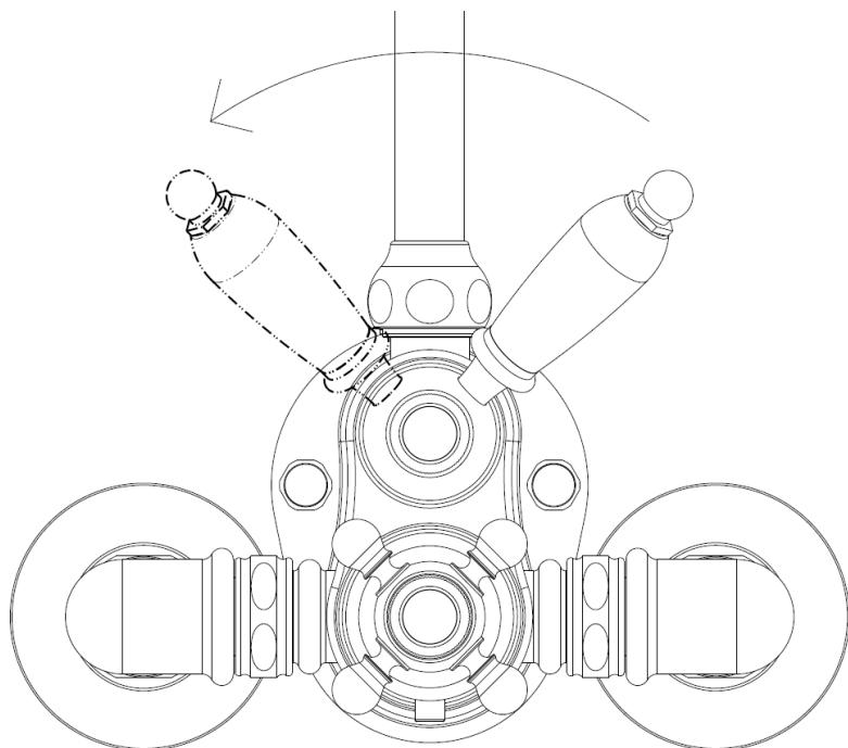
Ruotando la manopola in senso antiorario si apre l'acqua e se ne regola la portata.
