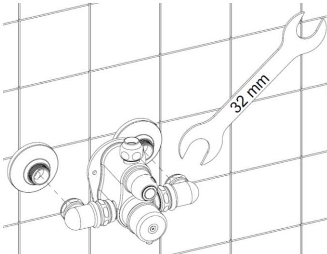
Montare il miscelatore termostatico alla parete serrando le calotte con chiave inglese da 32 mm.
