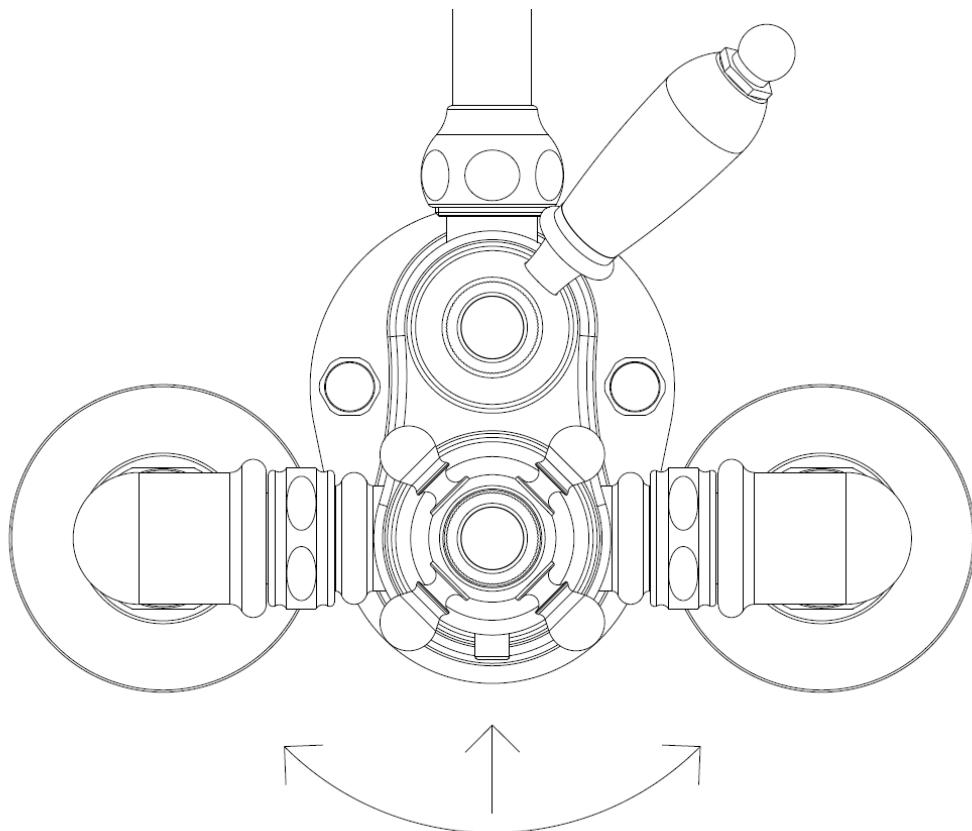
La manopola regola la temperatura dell'acqua miscelata (senso antiorario=calda / senso orario=fredda). E' previsto un blocco di sicurezza alla temperatura di 38°C; se si desidera aumentare la temperatura dell'acqua miscelata occorre premere il pulsante posto sulla manopola stessa.
