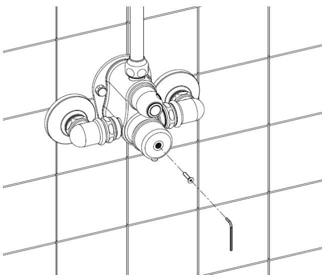
Svitare la vite dalla manopola per la regolazione della temperatura con chiave a brugola da 2,5 mm e non utilizzarla più.
