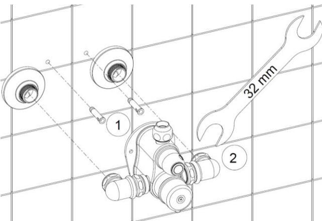
Inserire i tasselli nei fori e montare il miscelatore termostatico alla parete serrando le calotte con chiave inglese da 32 mm.
