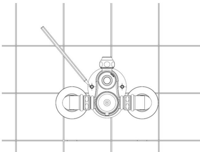
Markare la posizione dei fori di fissaggio.
