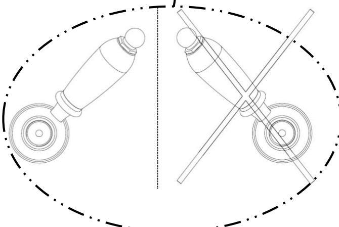
Schrauben Sie die Auf-Zu-Patrone mit einem 18-mm-Inbusschlüssel ab (4).
