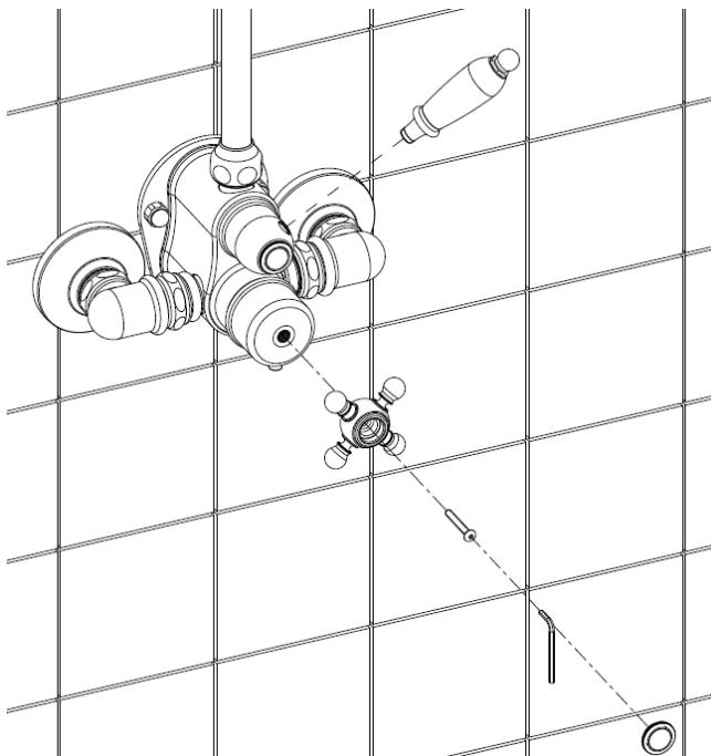
Inserire la manopola a croce sulla manopola di regolazione della temperatura e serrare con la vite utilizzando una chiave a brugola da 2,5 mm.
