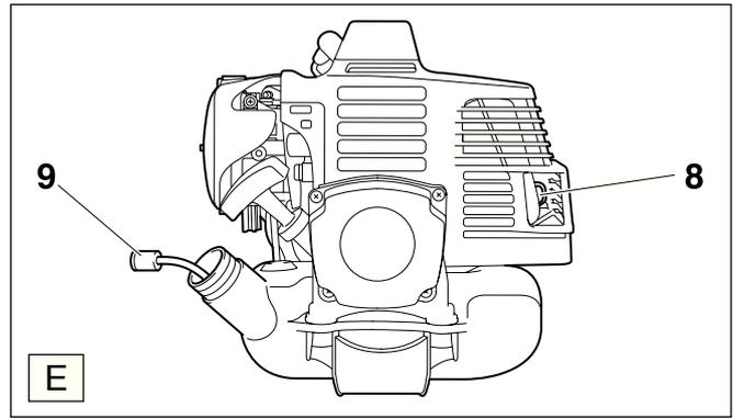
Требуемое карбюратору горючее всасывается через фетровый фильтр всасывающей головки (E/9).
