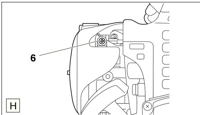
**Внимание:** Режущий инструмент на холостых оборотах двигаться не должен! Если же режущий инструмент на холостом ходу движется, необходимо произвести регулировку холостого хода.
