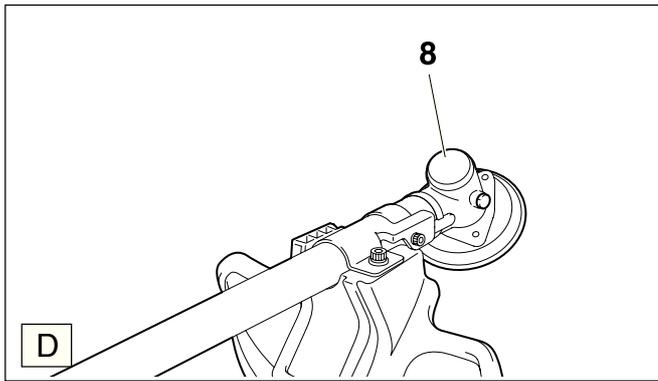
После 50 часов работы уголкового редуктора (D/8) следует проверить в специализированной мастерской фирмы MAKITA и при необходимости наполнить его смазкой.
