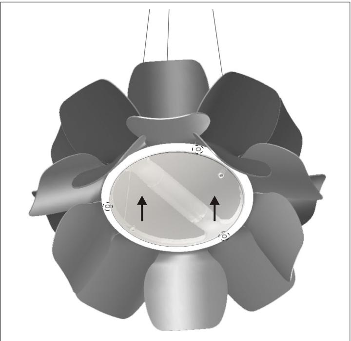
9- Volver a girar las pinzas desde la parte superior de la lámpara asegurando que el cristal queda bien sujetado al anillo. Ver Fig.9.
