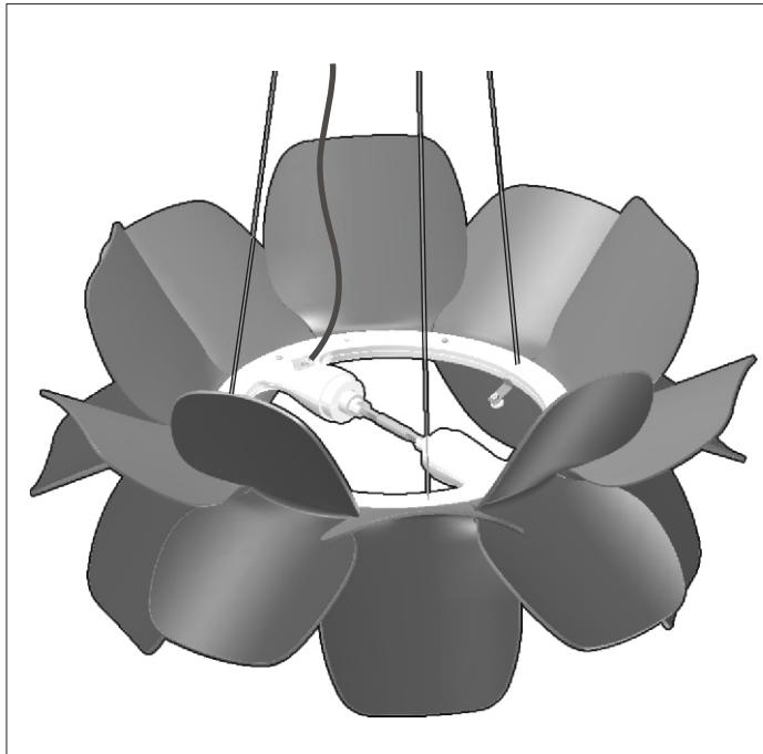
7- Colocar el cristal difusor inferior, para ello proceder de la siguiente manera: girar las pinzas de sujeción hacia el interior del cristal. Ver Fig.7.
