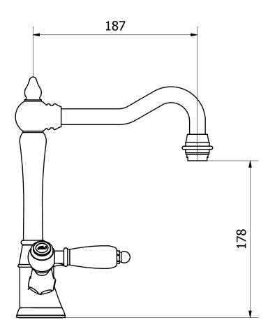
Foro sanitario: min Ø38 mm max Ø45 mm
