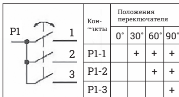
Схема коммутации переключателя SA1
