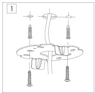
1.Подготовьте место для установки светильника, разметьте расположение крепежных отверстий, пользуясь основанием светильника в качестве шаблона, вставьте в отверстия дюбели. Закрепите основание светильника на стене при помощи двух шурупов.
