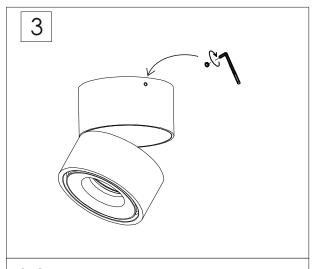
3. Закрепите светильник на основании, затянув два потайных винта при помощи Г-образного ключа.
