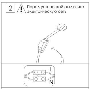
2. Подключите провода питания к клеммной колодке светильника, руководствуясь символами на колодке.
