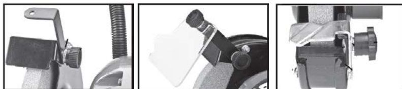
Рис.2 Установка упоров и защитных экранов
