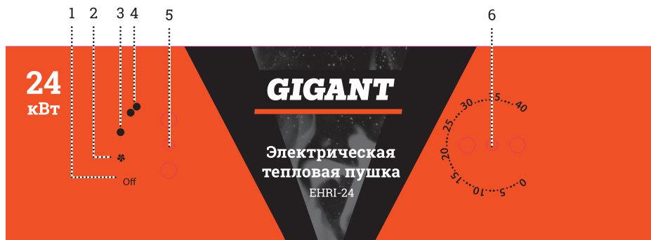
Рис. 3. Панель управления для моделей EHRI-24, EHRI-30: 1) положение выключения прибора, 2) положение режима вентиляции без нагрева, 3) положение частичной мощности нагрева, 4) положение полной мощности нагрева, 5) ручка переключателя режимов, 6) ручка регулировки термостата
