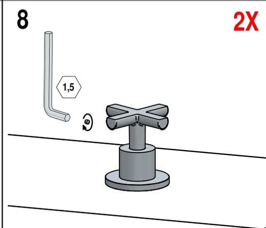
**SOSTITUZIONE VITONE / CERAMIC DISC VALVE**
