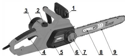
1-рычаг тормоза; 2-крышка масляного бачка; 3-крышка электродвигателя; 4-выключатель; 5-крышка цепи; 6-регулятор натяжения цепи; 7-винт крепления шины; 8-шина; 9-цепь пильная
