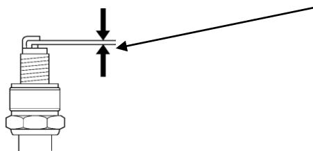
Д. Проверьте состояние уплотнительной шайбы свечи зажигания, и осторожно вверните свечу зажигания рукой, чтобы избежать повреждения резьбы.
