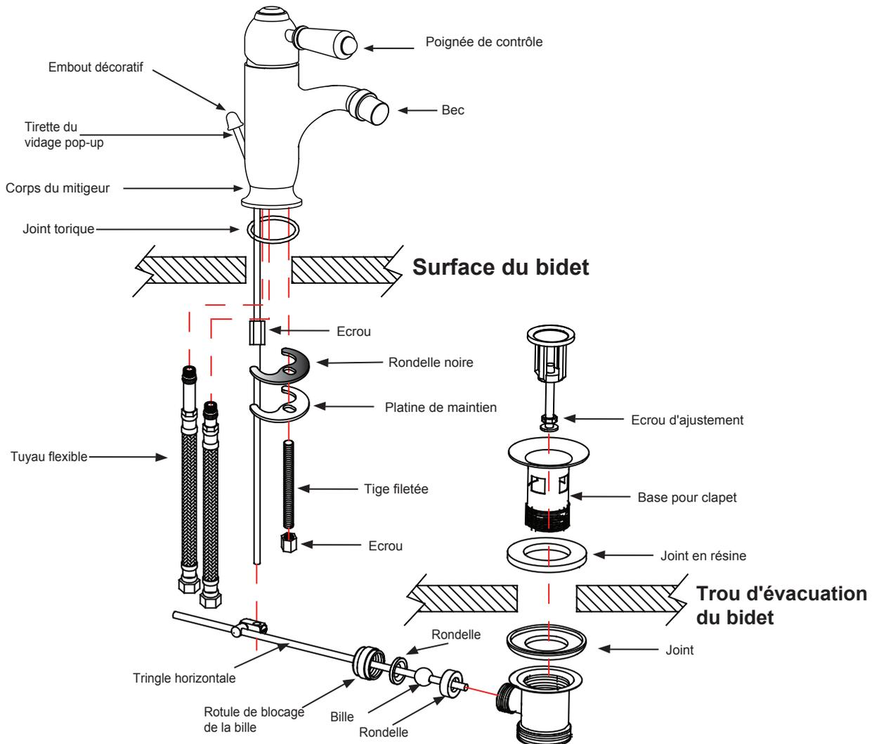
1. Insérez le joint torique dans la rainure dans la partie inférieure du corps du mitigeur.
