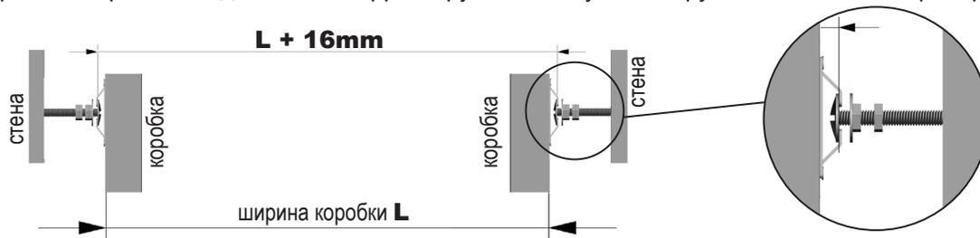
**9.** Произведите установку коробки с кронштейнами на болты с петлевой стороны и зафиксируйте гайкой. Аналогичным образом установите коробку и с противоположной стороны.
