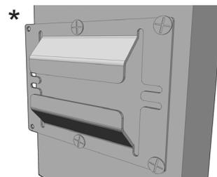
**8.** Замерьте ширину коробки, прибавьте 16 мм и получите требуемое расстояние между болтами на всех трех уровнях. При необходимости откорректируйте его путем выкручивания болтов. Проверьте уровень всех болтов.
