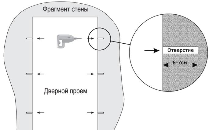
**4.** Произведите полное забивание пластиковых дюбелей в просверленные отверстия. После этого рекомендуется сделать контрольную прочистку внутреннего канала дюбеля насквозь сверлом 4,5 мм во избежание попадания мусора.
