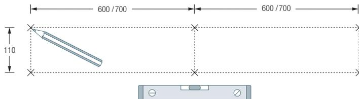
**HINWEIS** Achten Sie darauf, dass die Markierungen (und die anschließenden Bohrungen) horizontal und vertikal zueinander stehen, da ansonsten die Garderobe nicht waagrecht montiert werden kann (verwenden Sie dazu eine Wasserwaage).
