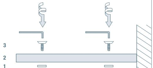
Legen Sie die Holzablage (2) auf und fixieren Sie diese vorsichtig mit den Senkkopf-Holzschrauben (3) (verwenden Sie dazu den Inbusschlüssel 3 mm).
