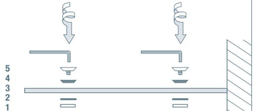
Legen Sie die Glasablage (3) mit der satinierten Seite nach unten auf und fixieren Sie diese vorsichtig mit den Senkkopf-Glasschrauben (5) und den Kunststoffhülsen (4) (verwenden Sie dazu den Inbusschlüssel 3 mm).
