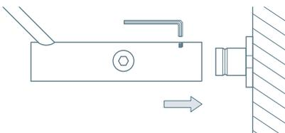
**5** Fixieren Sie die Wandgarderobe mit den sechs Madenschrauben an den Hutrosetten (verwenden Sie dazu den Inbusschlüssel 2 mm).
