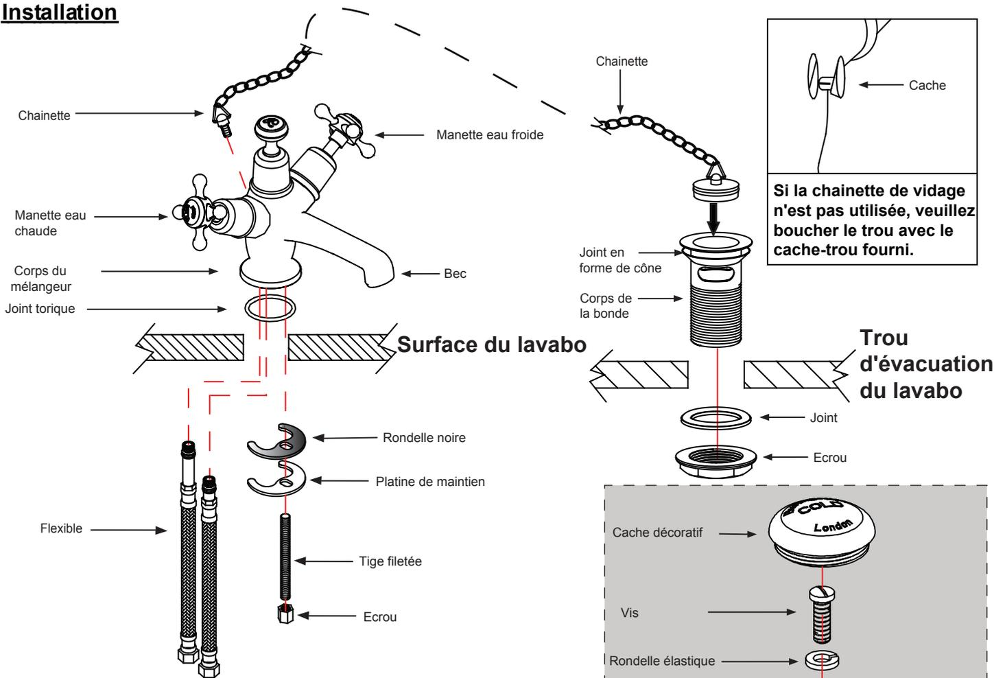
1. Insérez le joint torique dans la rainure dans la partie inférieure du corps du mélangeur.
