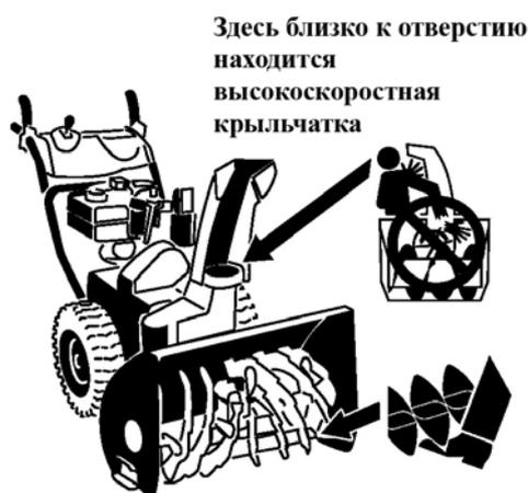
Низкоскоростной шнек имеет двигающуюся зону защемления, расположенную близко к отверстию.
