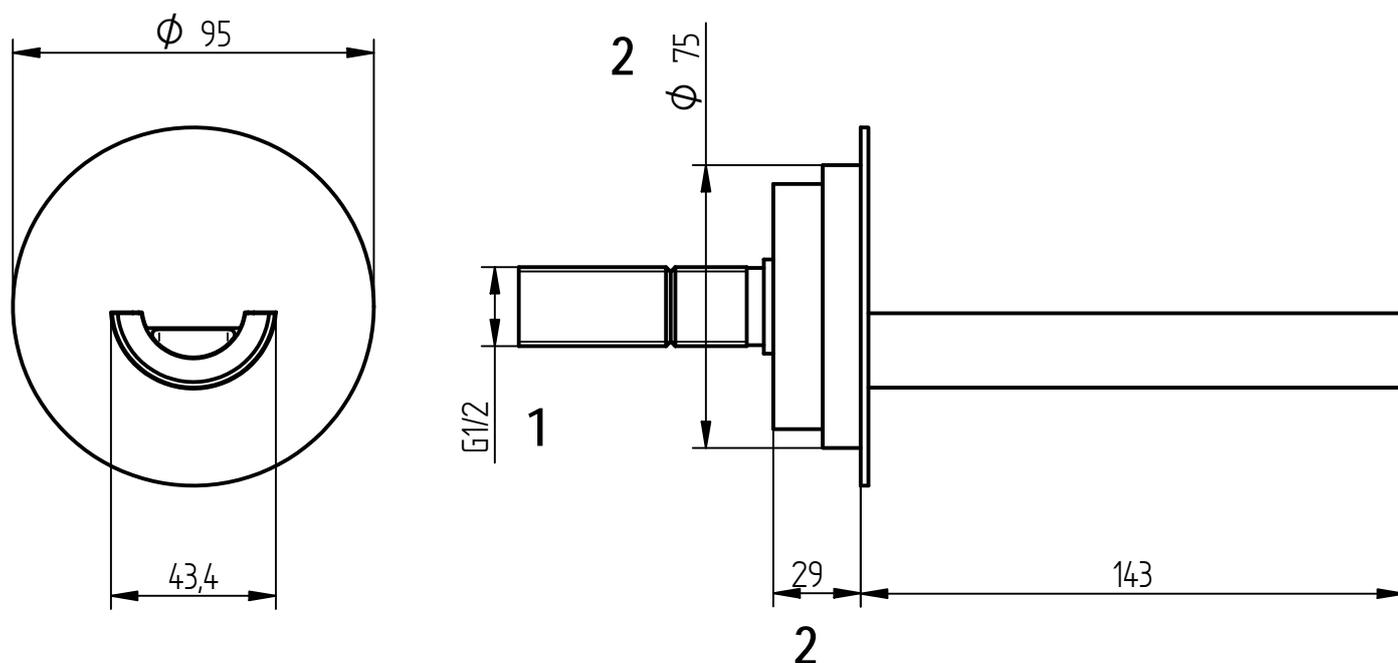
1 = Il tubo di alimentazione da 1/2" deve trovarsi minimo a 29 mm dentro il filo muro compreso di rivestimento
