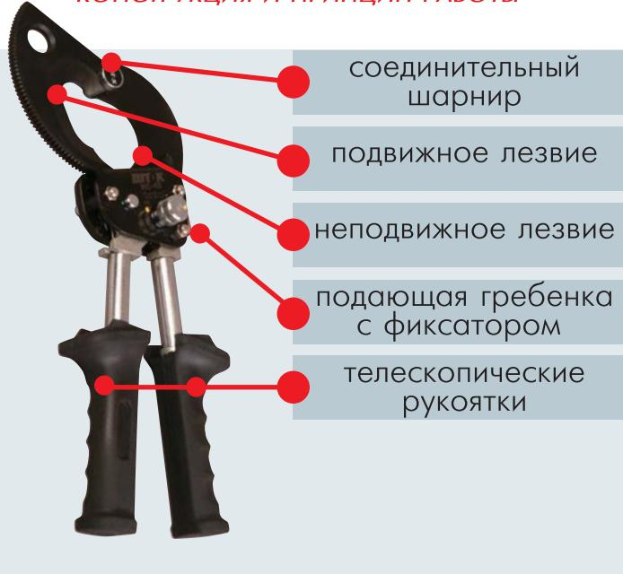
этих ножниц осуществляется в ходе поворота подвижного лезвия вокруг соединительного шарнира. Благодаря оригинальной геометрии лезвий в каждый момент реза достигается равномерное всестороннее воздействие режущего контура на разрезаемый участок. Это обеспечивает точность реза, минимальную деформацию и отсутствие "вытягивания" жил кабеля.
