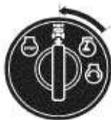
Система ROS в положении ON (эксплуатация при движении задним ходом)
