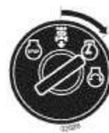
Двигатель в положении ON (обычный режим эксплуатации)
