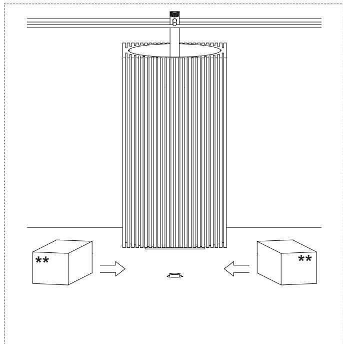
**IT\_3** Approssimare il lavabo allo scarico, inserire sotto il lavabo due punti di appoggio.
