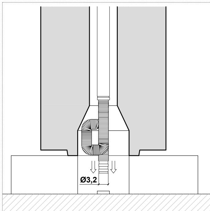
**IT\_4** Collegare il tubo flessibile del lavabo allo scarico a pavimento. Rimuovere infine i due punti di appoggio.
