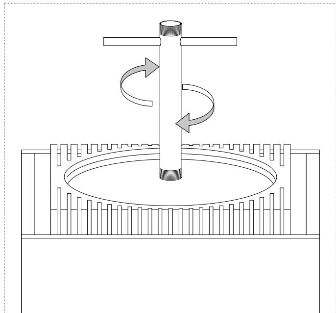
**IT\_1** Avvitare il perno di sollevamento presente in dotazione alla piletta di scarico del lavabo
