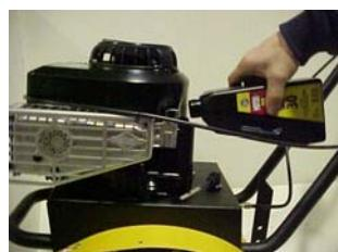
Tøm maskinen for brændstof. Lad motoren køre indtil karburatoren er helt tom (motoren stopper af sig selv). Hvis der efterlades brændstof i tanken i en længere periode kan eventuelle urenheder i benzin'en tilstoppe karburatoren hvilket kan medføre besværlig start, tab af ydeevne etc.
