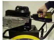
In der horizontalen Lage des Motors ist am Ölstab der Ölstand ablesbar.
