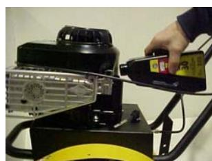
Удалите все топливо из бака. Запустите двигатель до его полной остановки, пока остаток топлива в карбюраторе не будет исчерпан. Если в баке будут долго находиться остатки топлива, находящиеся в нем примеси могут засорить карбюратор, что приведет к трудностям при запуске двигателя, потере производительности и т.д.
