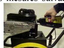
Lorsque le moteur est placé horizontalement, l'huile ne doit être visible que sur la jauge.
