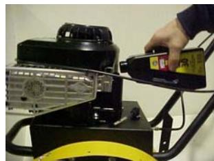
Töm maskinen på bränsle. Låt motorn gå tills förgasaren är helt tom (motorn stoppar av sig själv). Om bränsle lämnas kvar i tanken under en längre period kan eventuella orenheter i bensinen sätta igen förgasaren, vilket kan leda till att maskinen blir svårstartad, får sämre arbetskapacitet osv.
