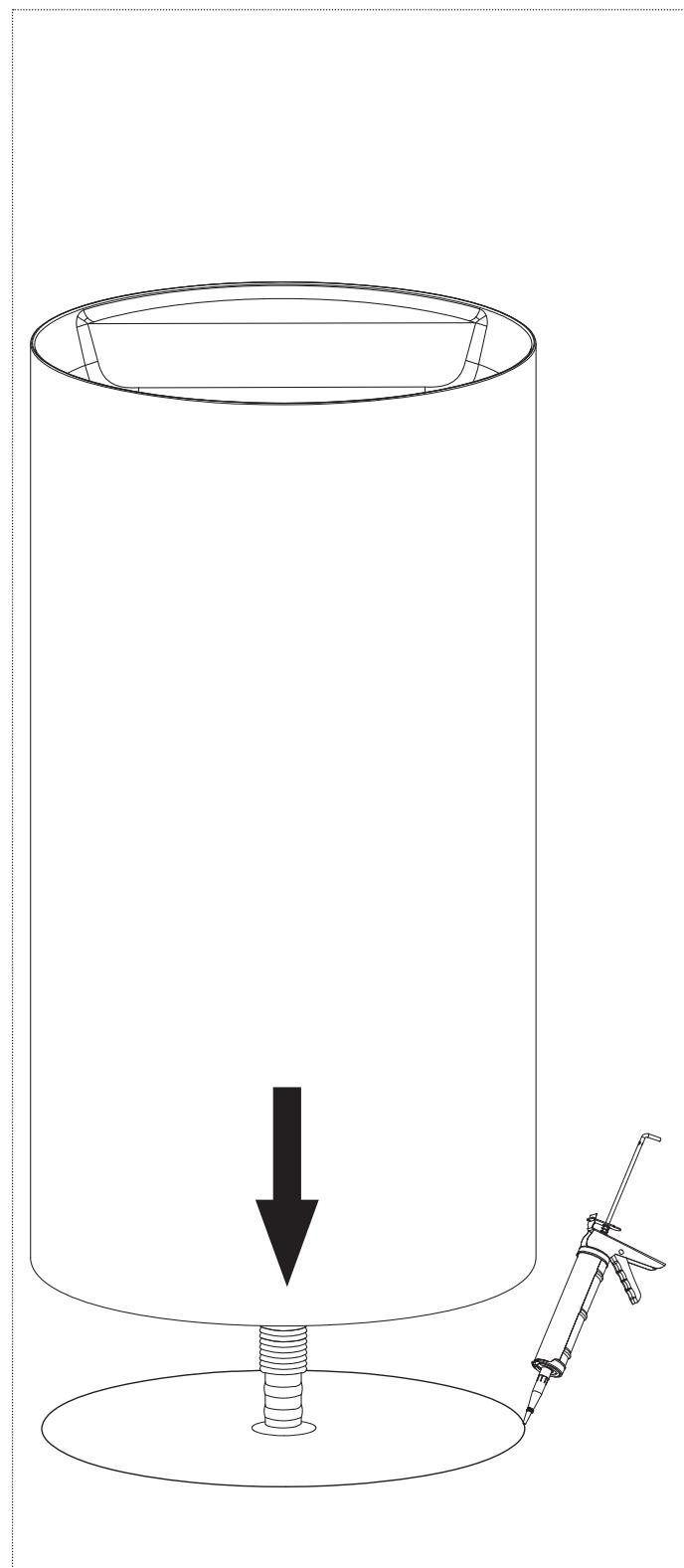
**IT\_3** Sollevare l'articolo e fissare il tutto con silicone o collante a seconda del tipo di pavimento.
