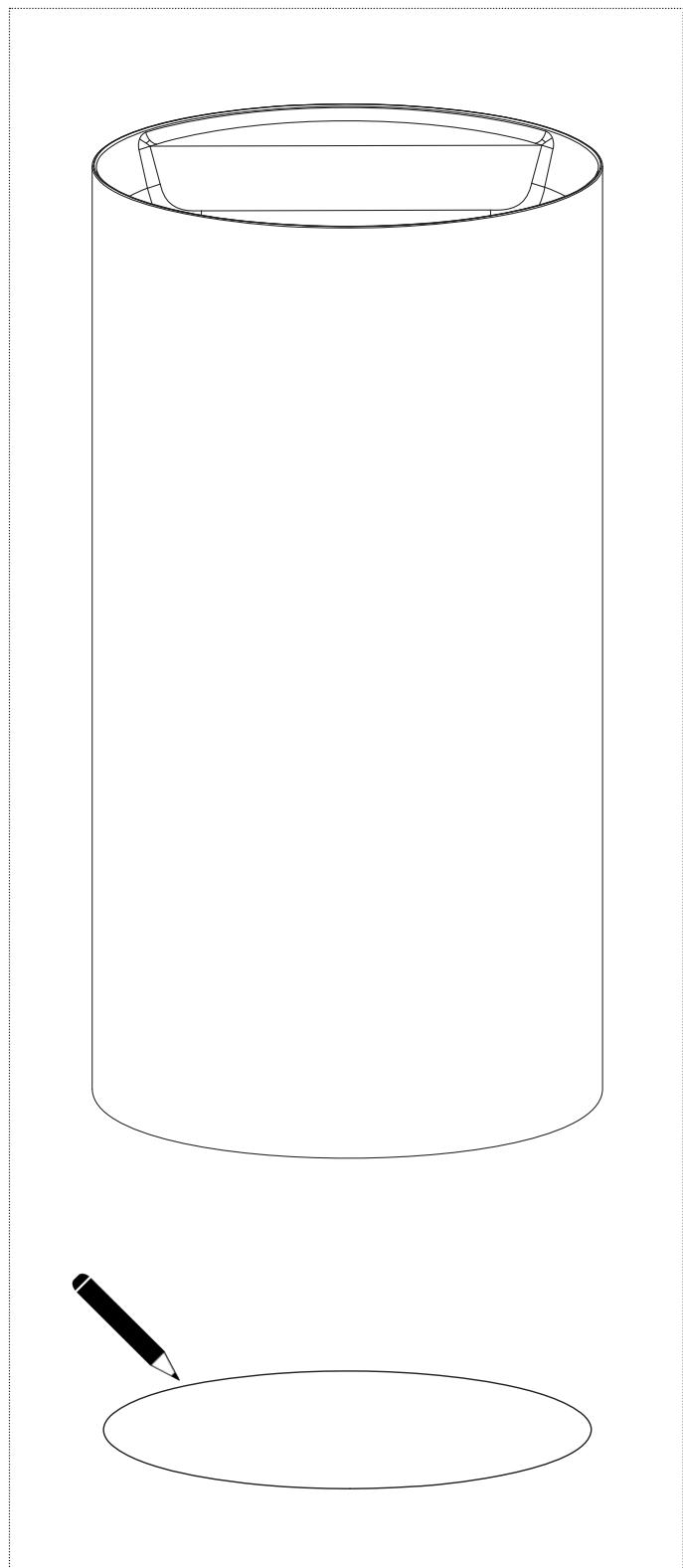
**IT\_2** Posizionare il lavabo quindi tramite una matita tracciare il profilo di base del lavello al suolo
