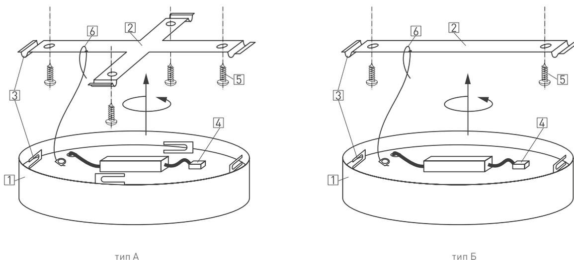
Рис. 1. Установка и подключение светильника
