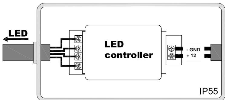
da inserire in scatola di derivazione IP44 alimentazione elettrica da 12V ± 1V con cavo inguainato da trasformatore IP30
