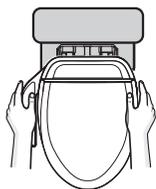
Задвиньте устройство в пластину, пока не услышите щелчок.
