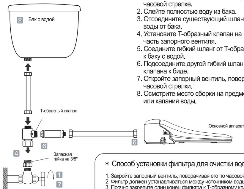
1. Закройте запорный вентиль, поворачивая его по часовой стрелке.
