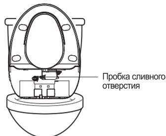
5. Закрутите пробку и установите аппарат обратно. Смотрите раздел "Пробный пуск" перед тем как снова использовать устройство.
