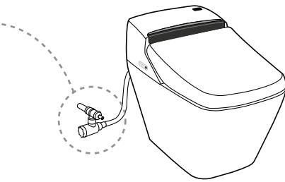
Если давление воды высокое, вода при чистке керамической чаши может разбрызгиваться или переливаться через край. Добейтесь уменьшения давления, регулируя клапан с помощью отвертки.
