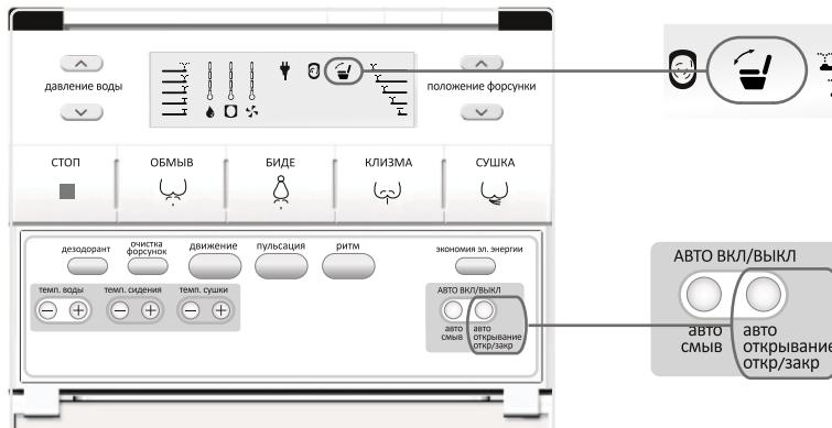
На устройстве индикации отображается «Автоматическое открывание/закрывание» крышки.
