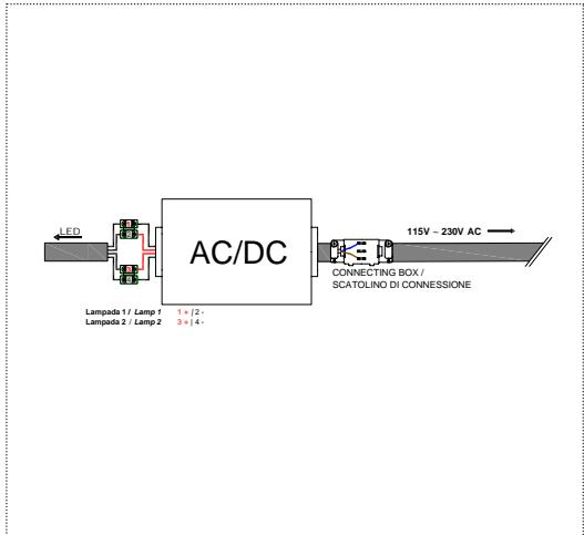
**4** Effettuare il collegamento elettrico: lampada - trasformatore - rete.
