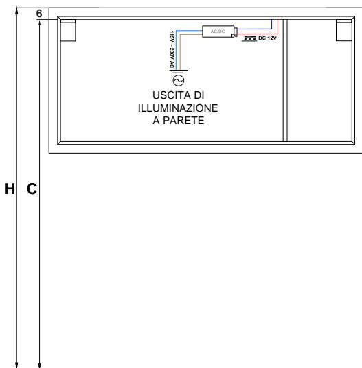
**1\_** Per fissare lo specchio all'altezza H desiderata. Tracciare la posizione dei fori di fissaggio delle squadrette S, facendo in modo che la piegatura si trovi all'altezza C ( $C = H - 6 \text{ cm}$ ).
