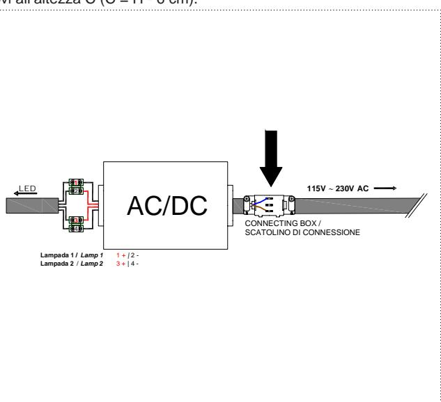
**3\_** Effettuare il collegamento elettrico fra la rete ed il trasformatore **AC/DC**, utilizzando lo scatolino di connessione in dotazione così come indicato.
