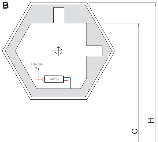
**IT\_1** Per fissare lo specchio all'altezza **H** desiderata. Tracciare la posizione dei fori di fissaggio delle squadrette **S** (FIG.2), facendo in modo che la loro piegatura si trovi all'altezza **C**
