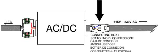
**IT\_3** Effettuare il collegamento elettrico fra la rete ed il trasformatore **AC/DC**, utilizzando lo scatolino di connessione in dotazione così come indicato.
