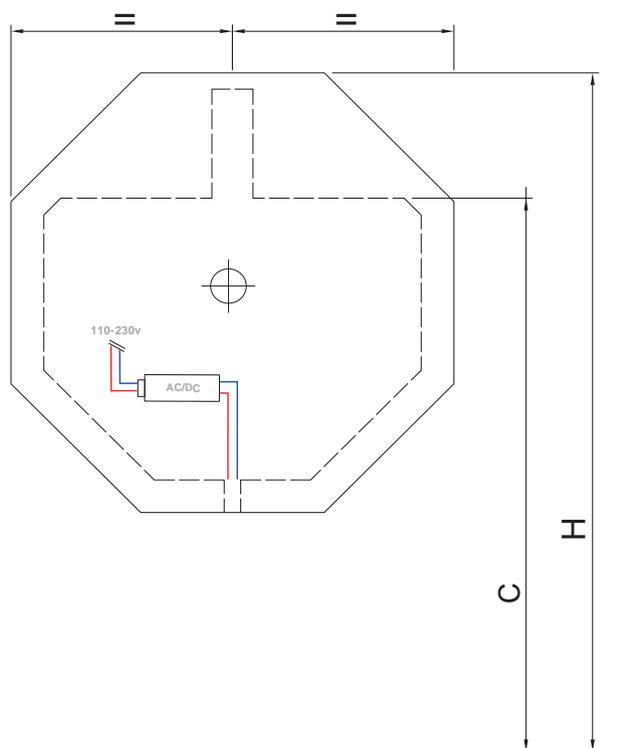
**IT\_1\_** Per fissare lo specchio all'altezza **H** desiderata. Tracciare la posizione dei fori di fissaggio delle squadrette **S** (FIG.2), facendo in modo che la loro piegatura si trovi all'altezza **C**
