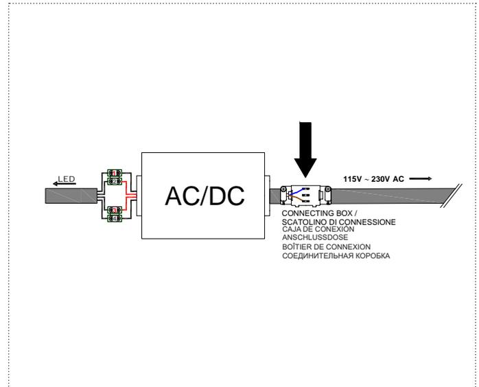
**IT\_3\_** Effettuare il collegamento elettrico fra la rete ed il trasformatore **AC/DC**, utilizzando lo scatolino di connessione in dotazione così come indicato.
