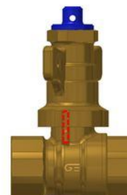
D) Bloqueo en 10% de apertura D) Lock in 10% opening
