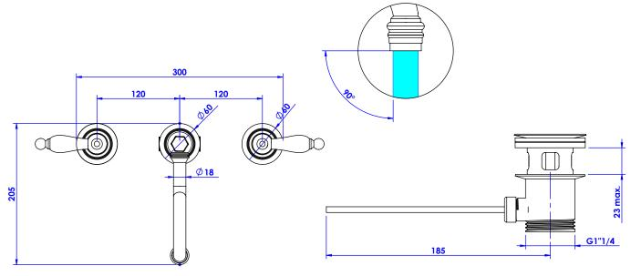
ø de perçage et entraxe recommandés. ø recommended drilling and centre distances.
