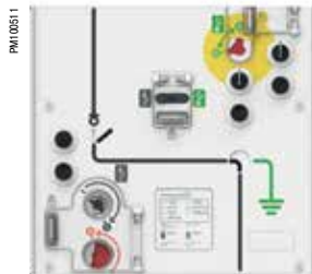
Привод CIT в ячейке 106T
