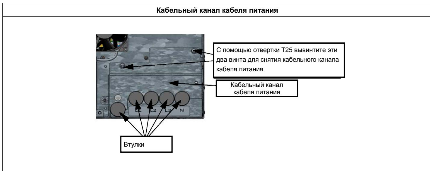
Выньте втулки из кабельного канала кабеля питания.
