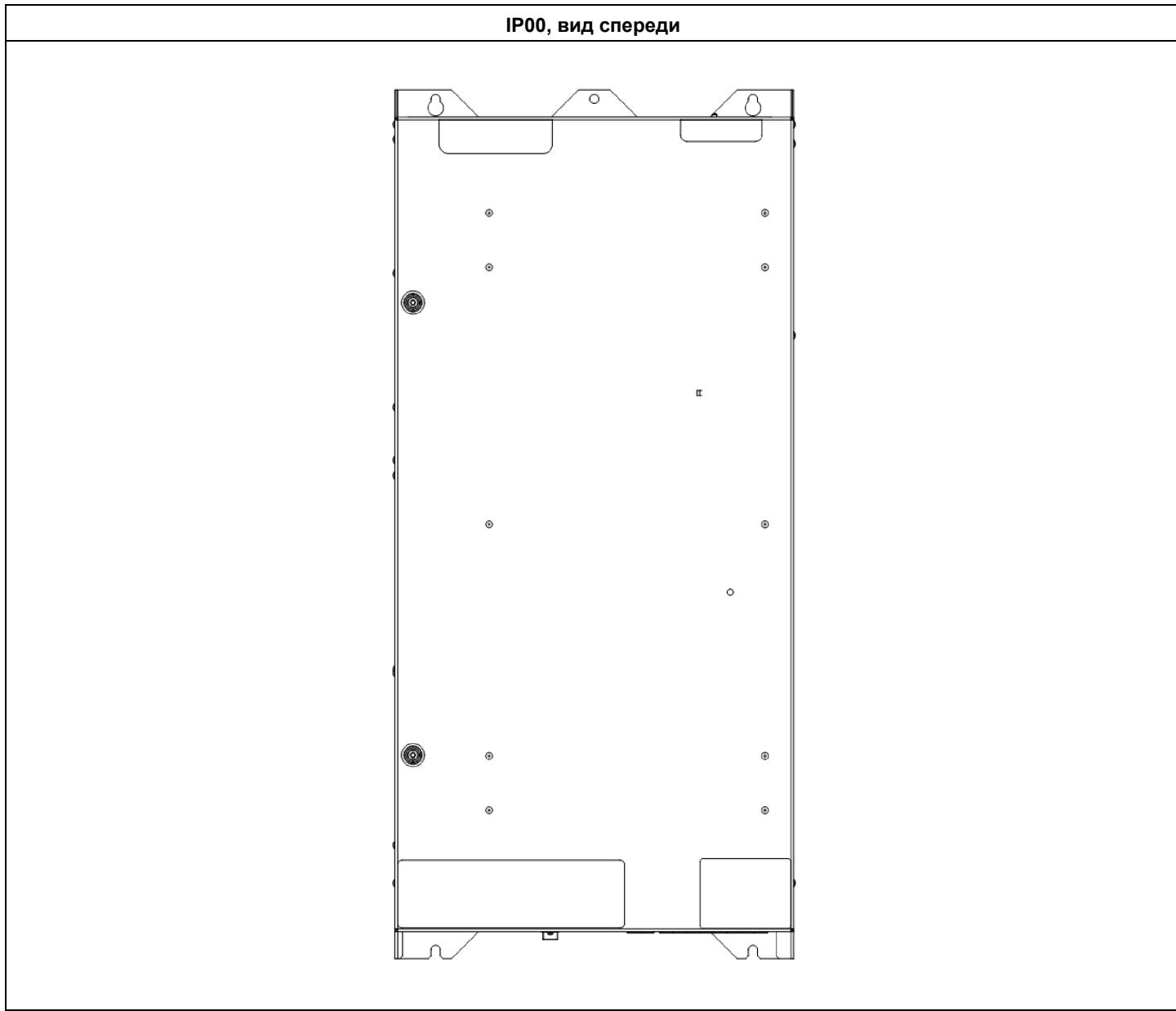
Общая высота, включая монтажные приспособления – 960 мм
