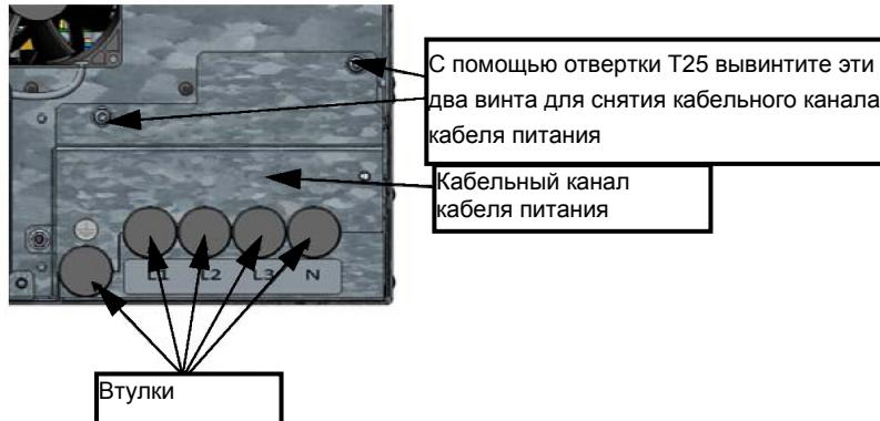
Выньте втулки из кабельного канала кабеля питания.
