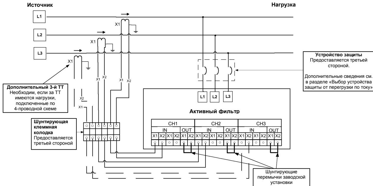
**ПРИМЕЧАНИЕ.** Шунтирующие перемычки заводской установки должны быть установлены.
