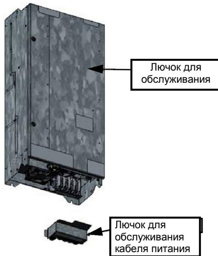
С помощью отвертки T25 снимите кабельный канал кабеля питания в нижней части блока.
