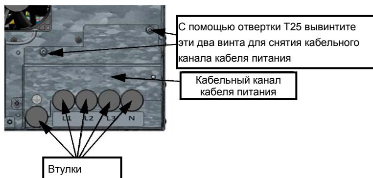
Выньте втулки из кабельного канала кабеля питания.
