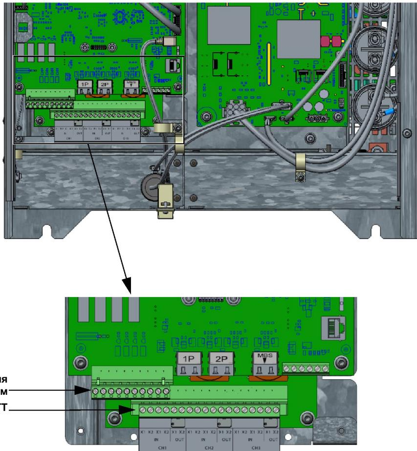
**Параллельное подключение 2 блоков – схема электрических соединений**
