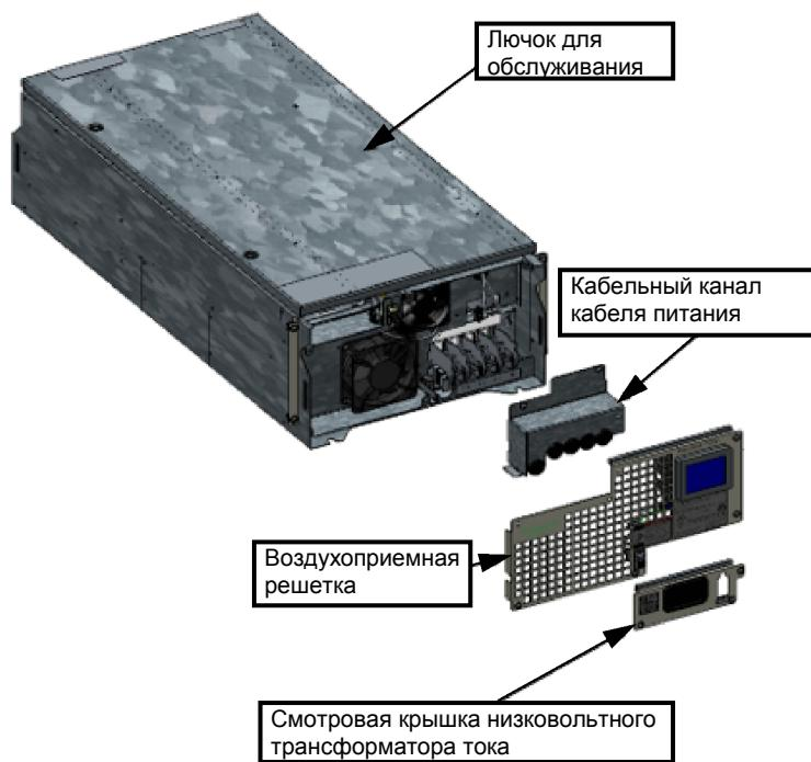
С помощью отвертки T25 снимите крышку низковольтного трансформатора тока, воздухоприемную решетку и кабельный канал кабеля питания.
