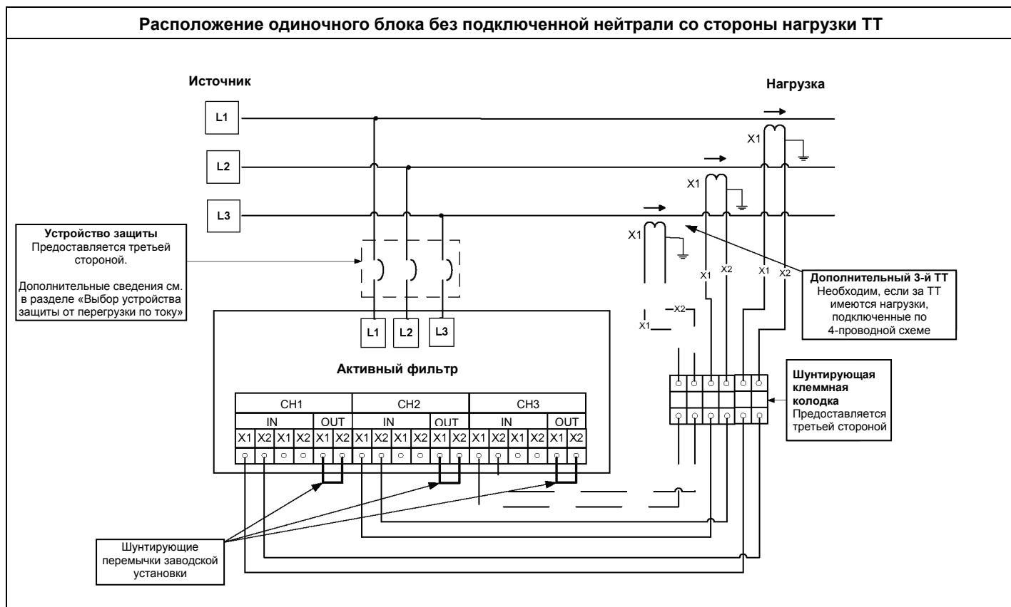
**ПРИМЕЧАНИЕ.** Шунтирующие перемычки заводской установки должны быть установлены.
