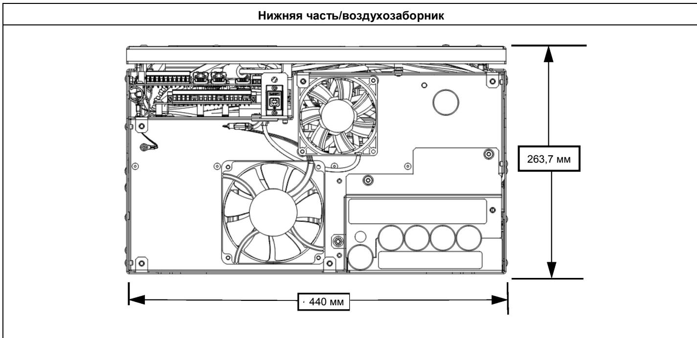
Используйте крепеж M8 для монтажа блока в шкаф. Схема расположения монтажных отверстий приведена на следующем рисунке.
