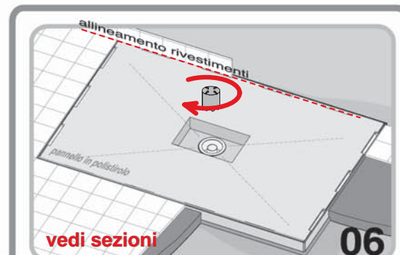
06 fissaggio bacino-dima esecuzione pavimento e rivestimento vedi sezioni
