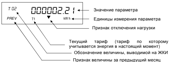
Рис. 2.3 Расположение информации на индикаторе
