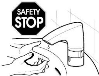
**ES** El flujo de agua se interrumpirá automáticamente pasados 60 segundos de su activación, como medida de seguridad, ante la invasión prolongada del campo de detección por parte de algún objeto. El grifo volverá a quedar operativo al retirar el objeto causante de la activación.
